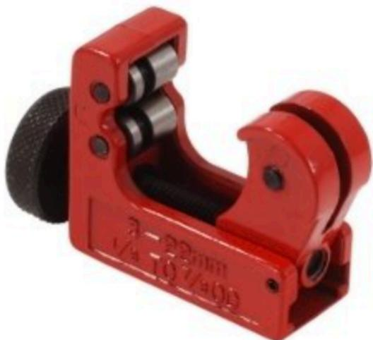
**Tagliatubi MINI 22 per misure 3-22mm e 1/8"-7/8"**. Rullini rettificato e scanalati, non filetta e rende agevole il taglio di tubi non sbavati o con colletti. Per misure sia in millimetri (mm) che in pollici ("). **Ingombro massimo 42 mm.**
